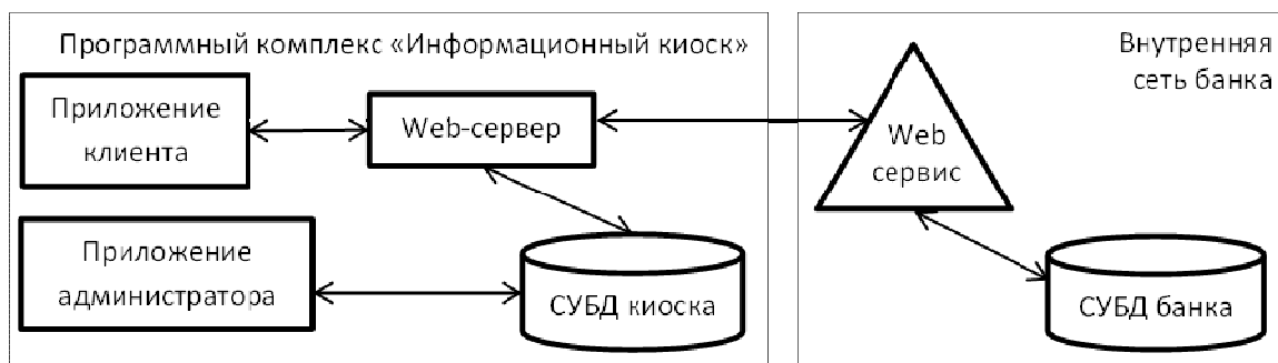
Рис. 1. Архитектура взаимодействия частей программного комплекса «Информационный киоск» и инфраструктуры банка
