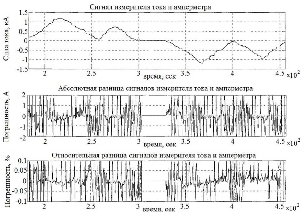
Рис. 5. Результаты испытания макета измерителя тока
