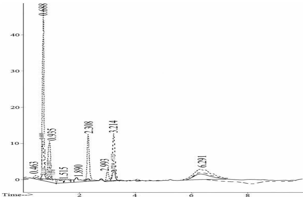
Рис. 9. Хроматограмма исходного селеноксантина, полученная на приборе ВЭЖХ при \lambda=254,4 нм, \lambda=224,4 нм, \lambda=210,4 нм, \lambda=300,4 нм
