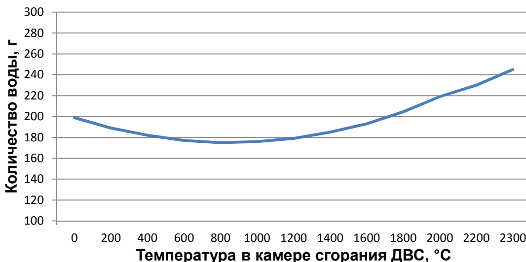
Рис. 2. Влияние температуры в камере сгорания ДВС MAZDA MZR-2,3 на количество воды, участвующей в сгорании при диссоциации.
