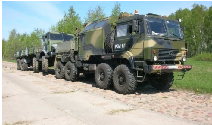
Рис. 2. Ремонтно-эвакуационная машина колесная легкая РЭМ-КЛ на шасси Урал-532362 при движении по крупно-булыжному участку комплексной испытательной трассы
