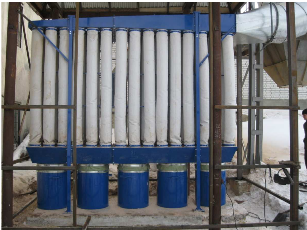
Рис. 1. Пылеуловитель ПУС-15000, вид сбоку
