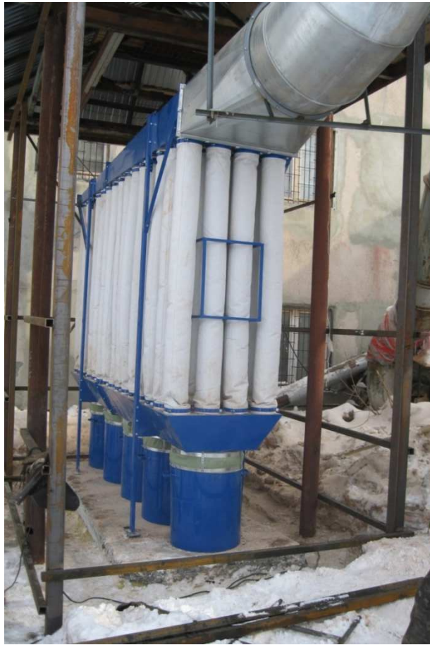
Рис. 2. Пылеуловитель ПУС-15000, вид с торца
