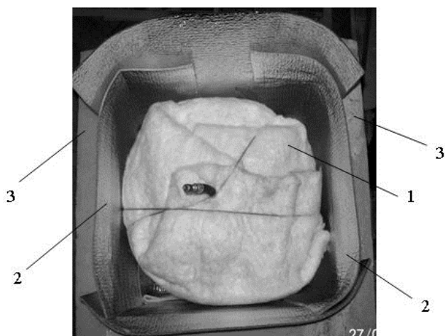
Рис. 5. Гидравлический аккумулятор в тепловой изоляции:
