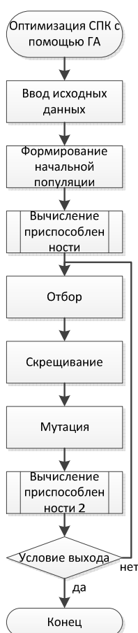
Рис. 1. Упрощенная блок-схема оптимизации параметров системы СПК
