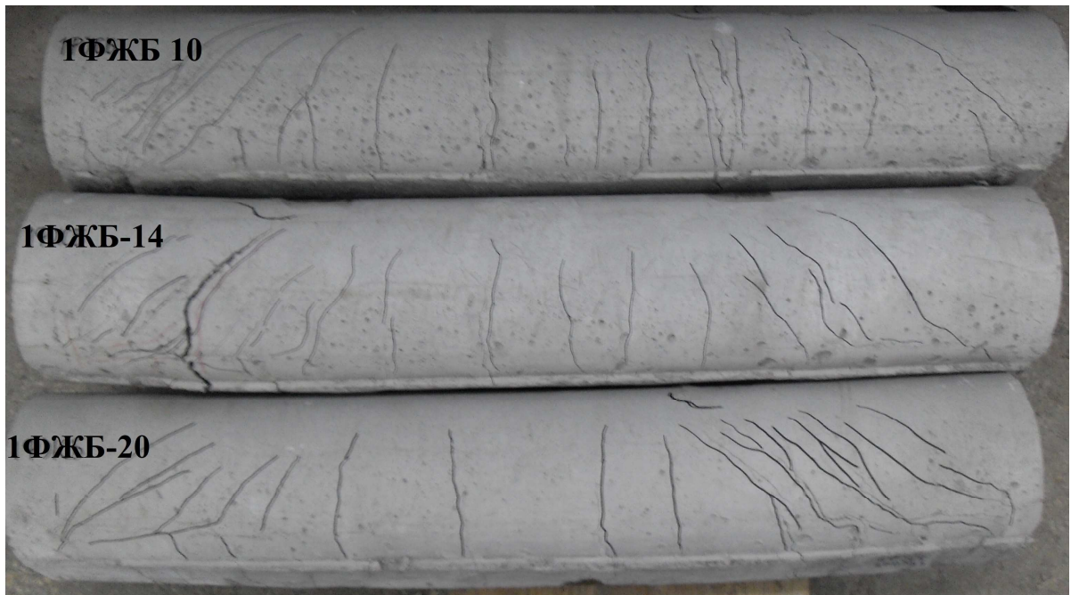
Рис. 4. Разрушение ФЖБ образцов Серии 1ФЖБ-10, 1ФЖБ-14, 1ФЖБ-20
