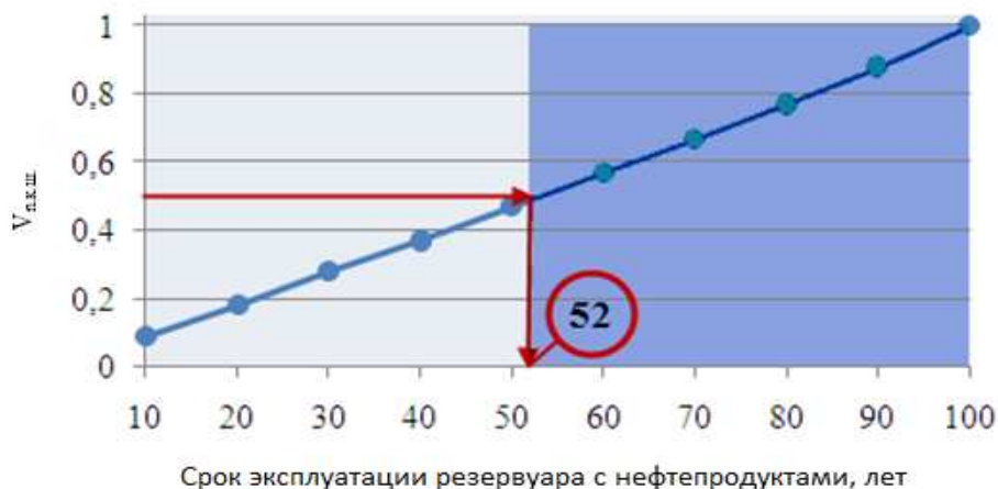
Рис. 3. Зависимость разрушающего воздействия природно-климатических и техногенных факторов от срока эксплуатации резервуаров с нефтепродуктами
